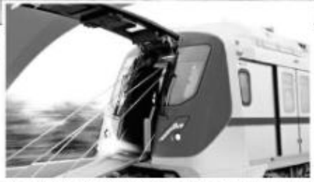
मेट्रो में आपातकालीन स्थिति के लिए इमरजेंसी डोर और ऑक्सीजन डिस्पेंसर फिटकर मौजूद है।
