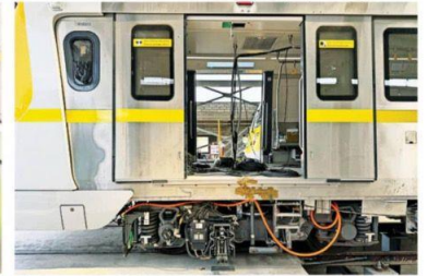
मेट्रो कोच का लोड टैट मशीनों के माध्यम से किया गया। ● लोकेश जैट्टे
